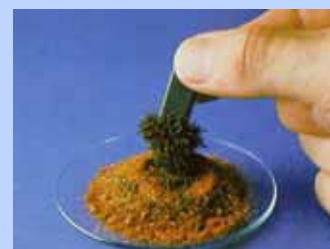
Διαχωρισμός ριζισμάτων σιδήρου από χώμα, σε ετερογενές μίγμα, με τη βοήθεια μαγνήτη.
