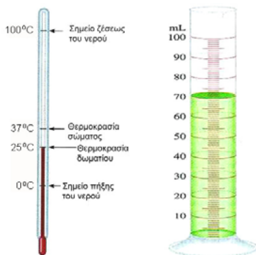
ΣΧΗΜΑ 1.1 α. Θερμόμετρο β. Ογκομετρικός κύλινδρος, για τη μέτρηση της θερμοκρασίας και του όγκου ενός υγρού, αντίστοιχα.
