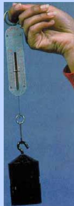
Το δυναμόμετρο είναι όργανο μέτρησης βάρους.
