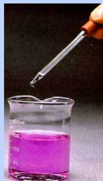
Με προσθήκη βάσης σε διάλυμα οξέος η φαινολοφθαλείνη που βρίσκεται στο διάλυμα χρωματίζεται κόκκινη.
