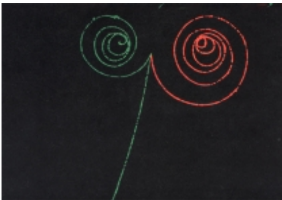
Εικ. 6.6 Ένα φωτόνιο ακτινοβολίας \gamma προσκρούει σε ένα ηλεκτρόνιο και μετατρέπεται σ' ένα ηλεκτρόνιο και ένα ποζιτρόνιο. Το φαινόμενο λέγεται δίδυμη γένεση. Ένα ποσό ενέργειας μετατράπηκε σε ύλη. Στη φωτογραφία η υλοποίηση του φωτονίου έγινε σε χώρο όπου υπάρχει μαγνητικό πεδίο. Το ποζιτρόνιο έχει αντίθετο φορτίο από το ηλεκτρόνιο και γι' αυτό διαγράφει σπειροειδή τροχιά αντίστροφης φοράς από αυτήν που διαγράφει το ηλεκτρόνιο.
